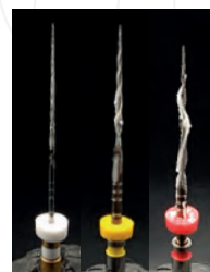
Fig 2: Immagine comparativa dei file dopo la rimozione dei detriti per illustrare le differenze nelle prestazioni di taglio
